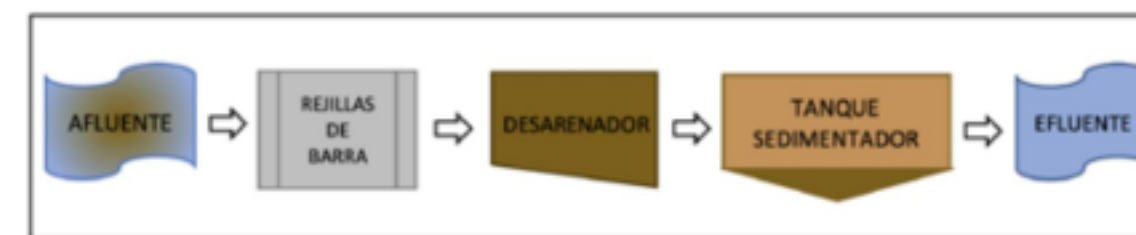
Figura 2: Diagrama de flujo del proceso de la PAS primaria
